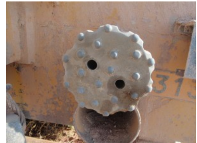
Bohrung bei den Messpunkten VES 1 und VES 5: Granit (weißer Staub) - Bohrkopf
